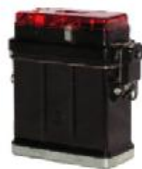
Konecová žárovková svítidla pro důlní vlaky kryt světla se vyráběl v červené modré a bílé barvě
