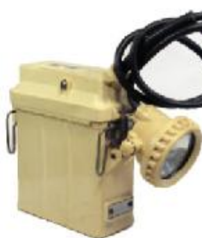
Akumulátorová přilbová svítidla elektrody akumulátorů byly niklkadmiové, elektrolytem je roztok hydroxidu draselného, zdrojem světla dvouvláknová žárovka Tungsram 3,6 V 0,8/0,5 A
