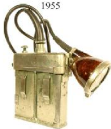
Akumulátorová přilbová svítidla elektrody akumulátorů byly niklkadmiové, elektrolytem je roztok hydroxidu draselného, zdrojem světla dvouvláknová žárovka Tungsram 3,6 V 0,8/0,5 A
