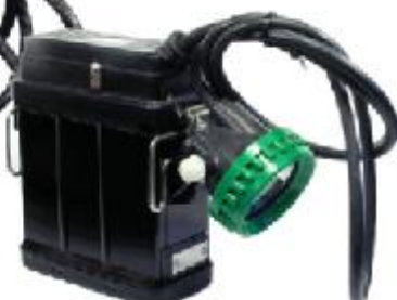
Akumulátorová přilbová svítidla elektrody akumulátorů byly niklkadmiové, elektrolytem je roztok hydroxidu draselného, zdrojem světla dvouvláknová žárovka Tungsram 3,6 V 0,8/0,5 A
