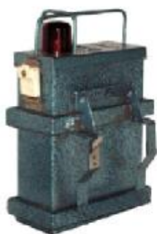
Konecová žárovková svítidla pro důlní vlaky kryt světla se vyráběl v červené modré a bílé barvě
