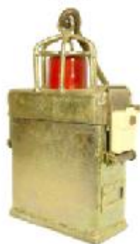
Konecová žárovková svítidla pro důlní vlaky kryt světla se vyráběl v červené modré a bílé barvě
