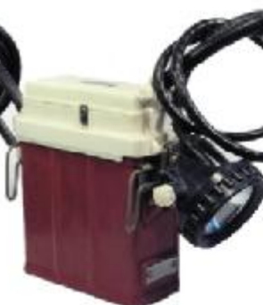
Akumulátorová přilbová svítidla elektrody akumulátorů byly niklkadmiové, elektrolytem je roztok hydroxidu draselného, zdrojem světla dvouvláknová žárovka Tungsram 3,6 V 0,8/0,5 A
